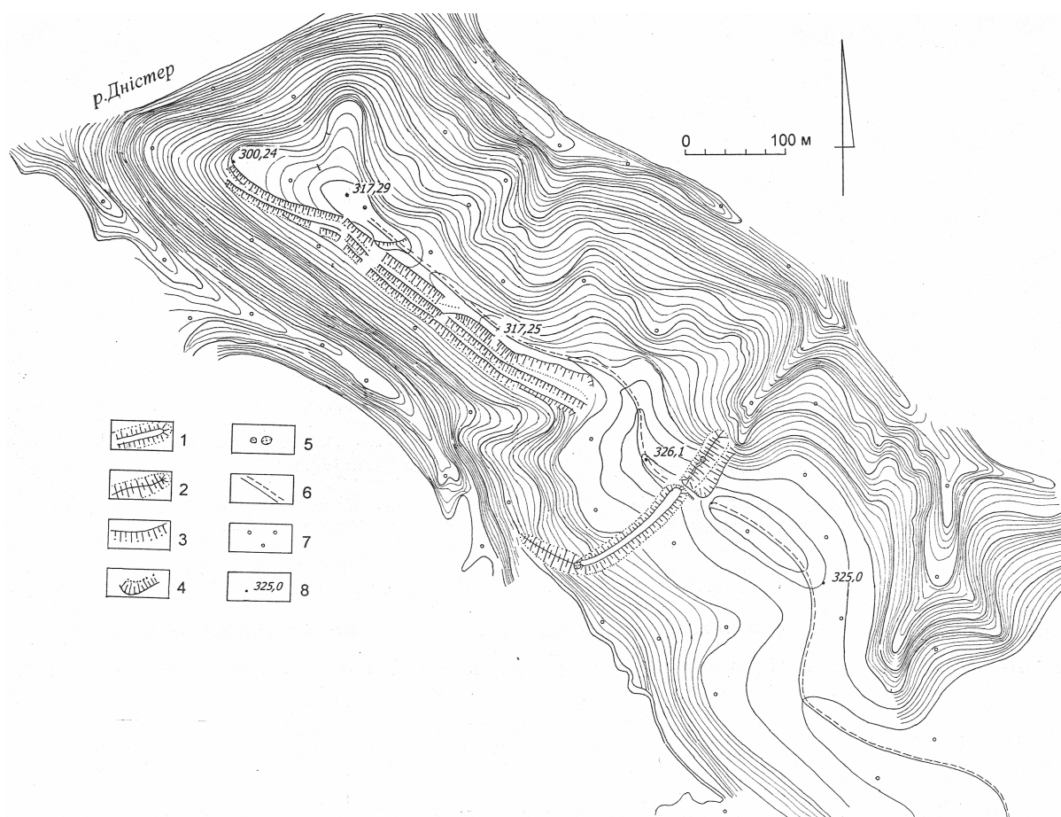
Рис. 5. План земляних укріплень городища IV. 1 – земляний вал з майданчиком-терасою на поверхні; 2 – земляний вал; 3 – ескарпований схил; 4 – рів; 5 – западини; 6 – лісова дорога; 7 – лісонасадження; 8 – висотна відмітка
