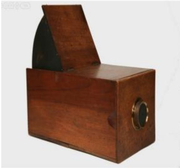
Камера-обскура переносна з вбудованим дзеркалом
